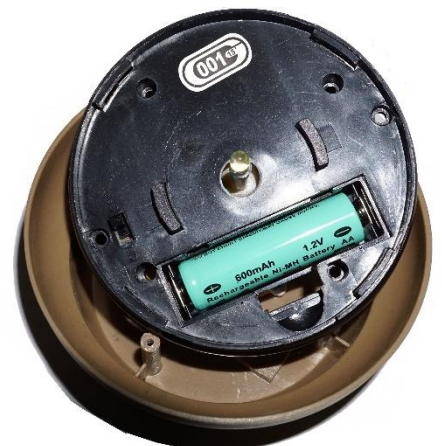
充電池(600mAh,1.2V)とLED 乾電池は絶対に入れないよう!
