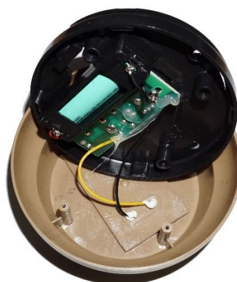
太陽電池から出た線が回路につながる
